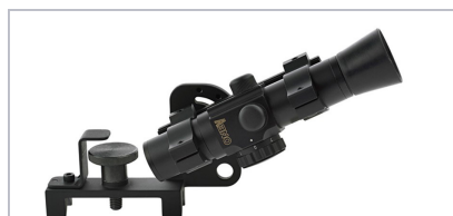
Einstellhilfe inkl. Zielfernrohr für eine normgerechte Beleuchtung
